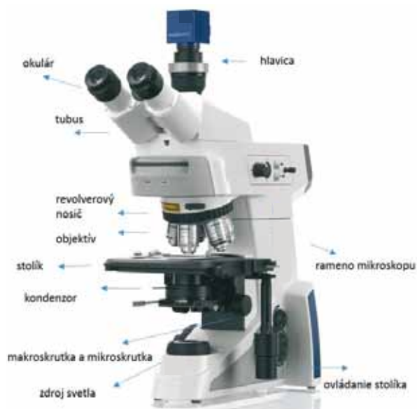
Obr. 1.11.2. Zloženie svetelného mikroskopu (autorka obrázku K. Schwarzová).
